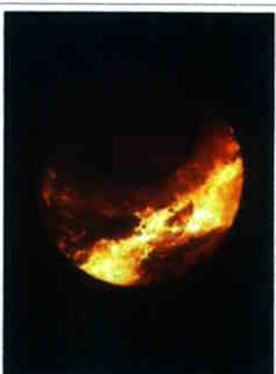
Un coup d'œil sur l'intérieur du four dans lequel les boues sont chauffées à plus de 600° Celsius. (Photo Le Soleil - M.P.)
